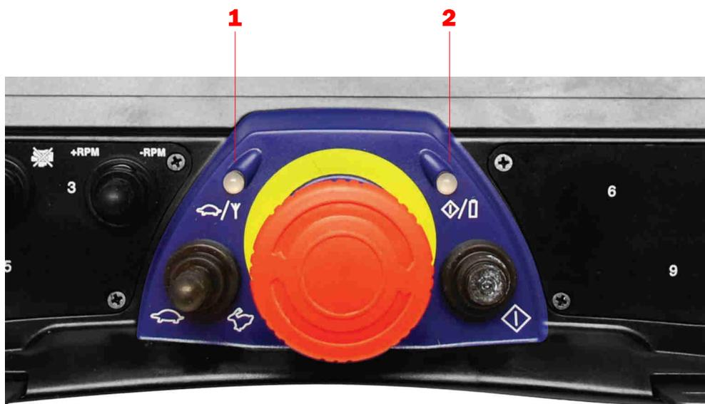
Figura 6.1 Indicatori di stato e allarme sulla pulsantiera.
