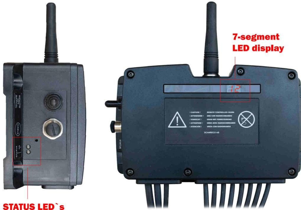
Figura 6.2 Luci di stato dell'unità centrale.
